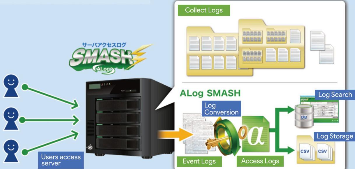
ALog SMASH diinstal pada server yang dimonitor dan berjalan sebagai service. Service mengumpulkan event logs dan mengonversi ke access logs untuk menunjukkan histori operasi pengguna.
